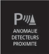
ANOMALIE<br>DETECTEURS<br>PROXIMITE | Série de doubles bips | Il peut y avoir un problème de système de capteurs de stationnement.<br>Faites vérifier le véhicule par un concessionnaire SUZUKI agréé. |
