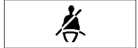
Questa spia si accende e/o lampeggia quando il conducente o il passeggero anteriore non allaccia la cintura di sicurezza. Per i dettagli riguardanti il sistema di avviso cintura di sicurezza non allacciata vedere il paragrafo "Cinture di sicurezza e sistemi di ritenuta bambini" in questa sezione.
