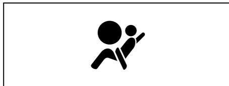
Quando il commutatore di accensione è in posizione "ON", la spia si accende per alcuni secondi per consentire di controllare il suo corretto funzionamento.
