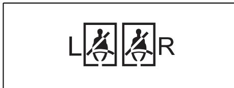
Questa spia si accende e/o lampeggia quando il passeggero posteriore non allaccia la cintura di sicurezza. Per i dettagli riguardanti il sistema di avviso cintura di sicurezza non allacciata vedere il paragrafo "Cinture di sicurezza e sistemi di ritenuta bambini" in questa sezione.
