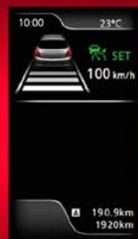
Affichage de l'écart et de la vitesse sélectionnés pour le régulateur de vitesse adaptatif.
