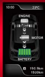
Intervention du soutien électrique et du flux d'énergie (uniquement pour les véhicules hybrides)
