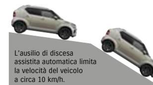
L'ausilio di discesa assistita automatica limita la velocità del veicolo a circa 10 km/h.
