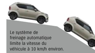
Le système de freinage automatique limite la vitesse du véhicule à 10 km/h environ.
